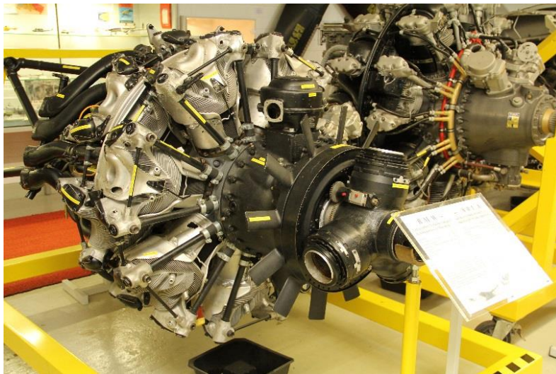
BMW-801A 14 Zylinder Doppelsternmotor Luftfahrtmuseum Laatzen Bild: UF
