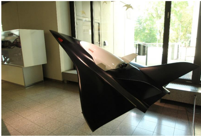
Modell des Projekts „Sänger“, welches Nutzlasten mit Hilfe von SCRAMJET Triebwerken bis an den Rand der Atmosphäre bringen sollte
