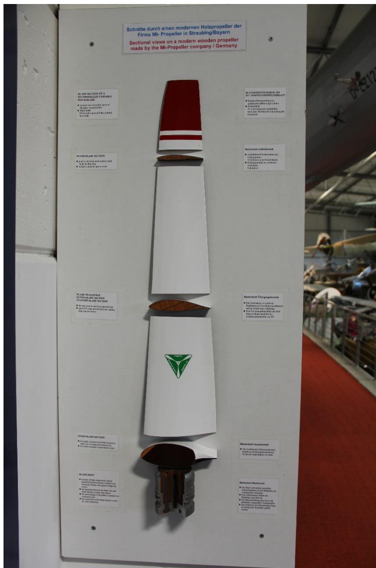
Moderner Flugzeugpropeller in Schichtbauweise Luftfahrtmuseum Laatzen. Bild: UF
