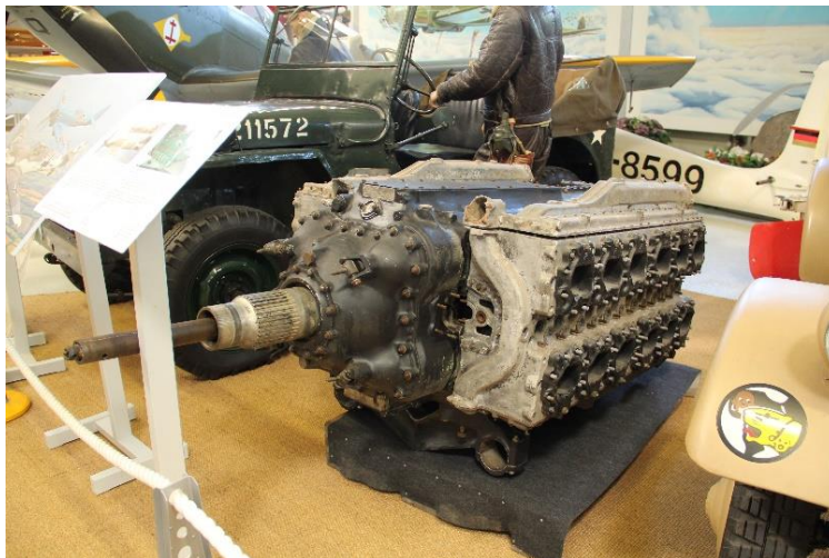
Hochleistungsflugmotor Napir Sabre 24 Zylinder doppel- V Motor mit 2 Kurbelwellen 36,8 l Hubraum 1790 kW, später 2570 kW
