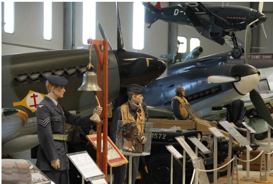
Vordergrund: Supermarine Spitfire mit 5 Blatt Propeller und stehendem V12-Motor, dahinter BF109 mit hängendem V12-Motor Luftfahrtmuseum Laatzen Bild: UF
