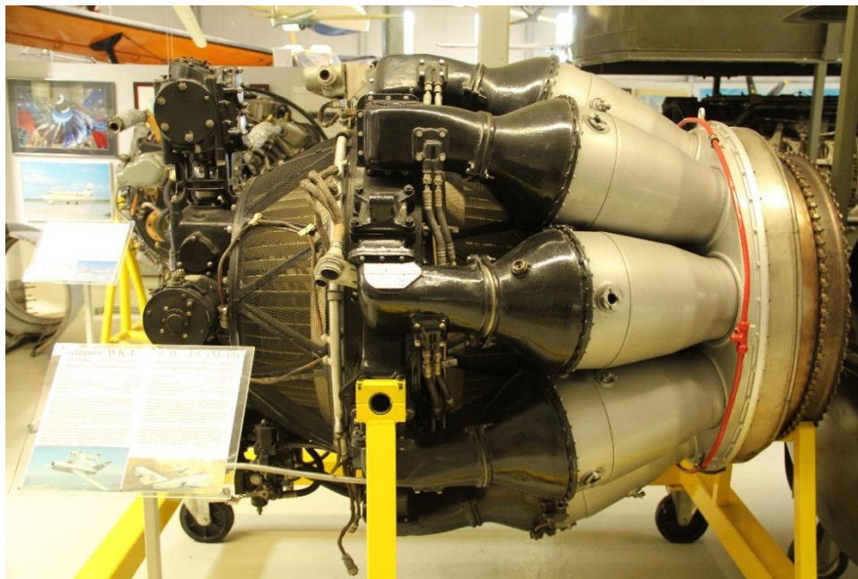
RD-45 Rolls Royce „Nene“ Triebwerk mit Radialverdichter. Gut zu erkennen sind die außen um das Triebwerk angeordneten Brennkammern die auf die Axialturbine führen. Luftfahrtmuseum Laatzen Bild: UF
