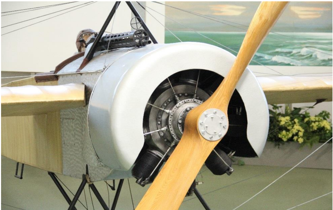
Umlaufmotor eingebaut. Die Motorverkleidung lenkt die Abgase vom Piloten weg. Luftfahrtmuseum Laatzen
